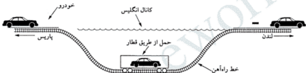
شکل ۵-۴۸. تونل کردن (Tunneling) یک خودرو از فرانسه به انگلستان.
