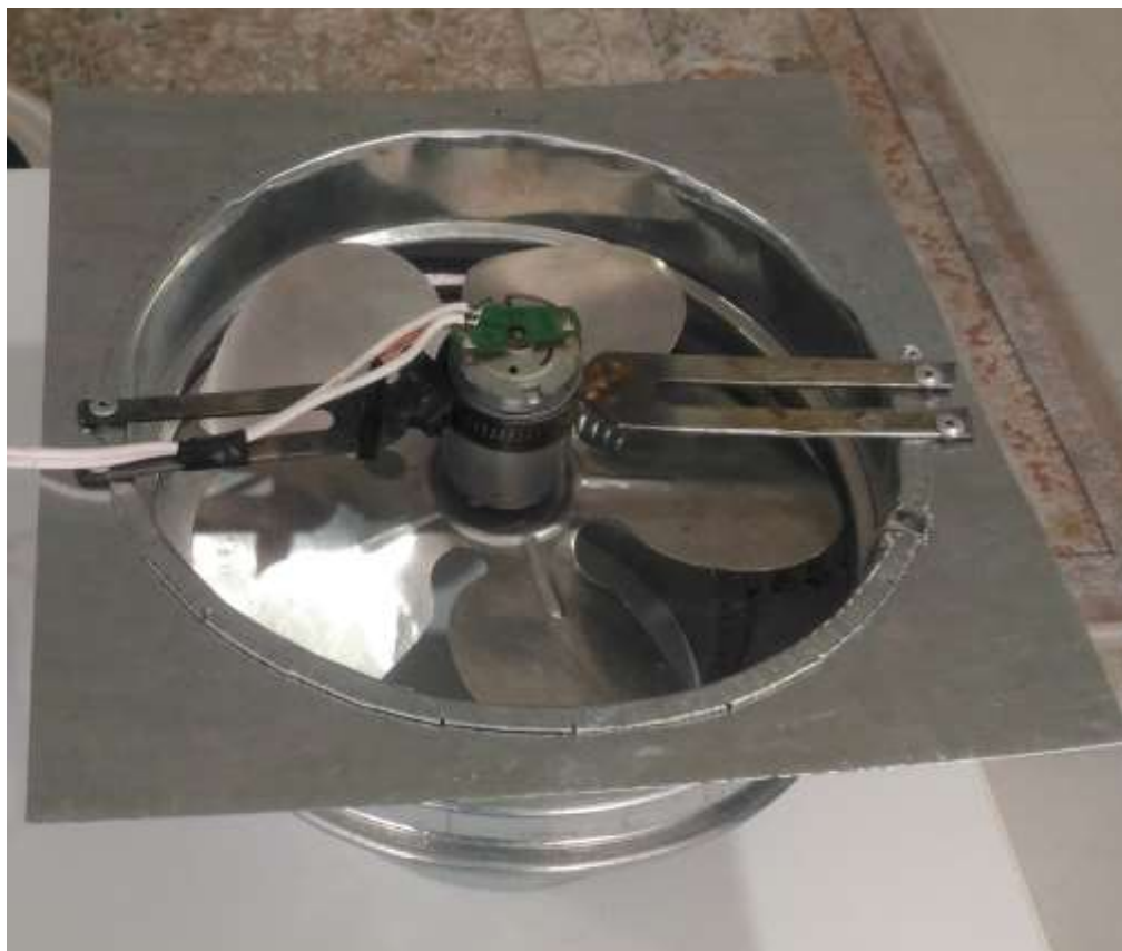
شکل (۵-۱۲) DC موتور نصب شده توربین
