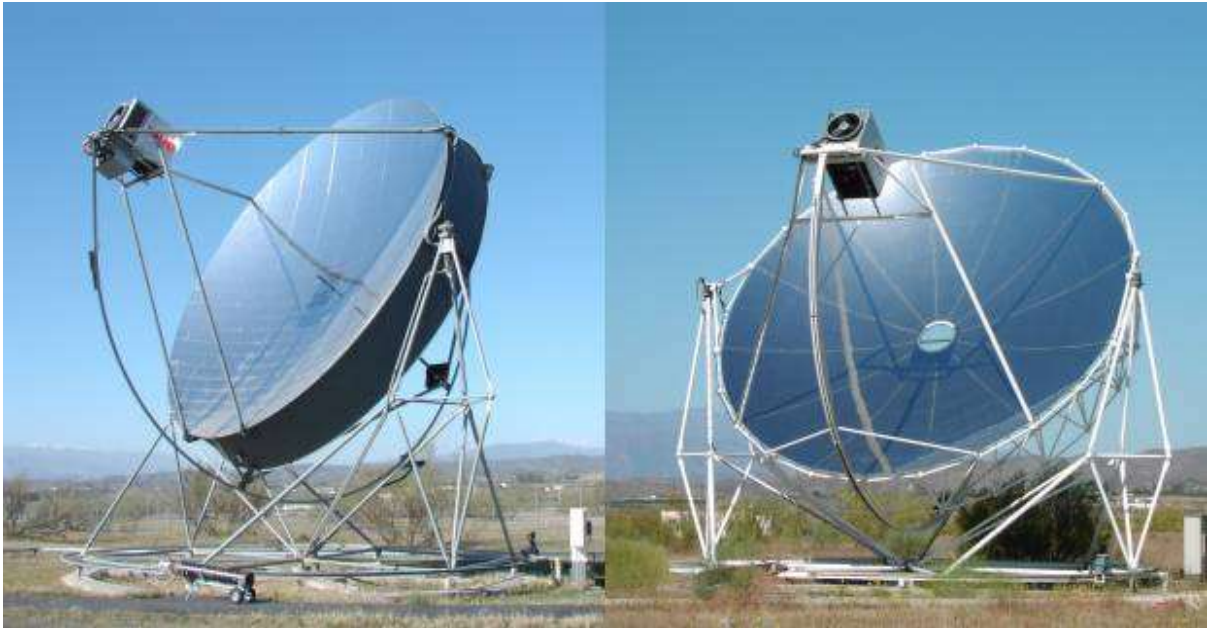
شکل (۱-۱۲) یک سیستم دریافت کننده بشقاب - استرلینگ [۲۰]
