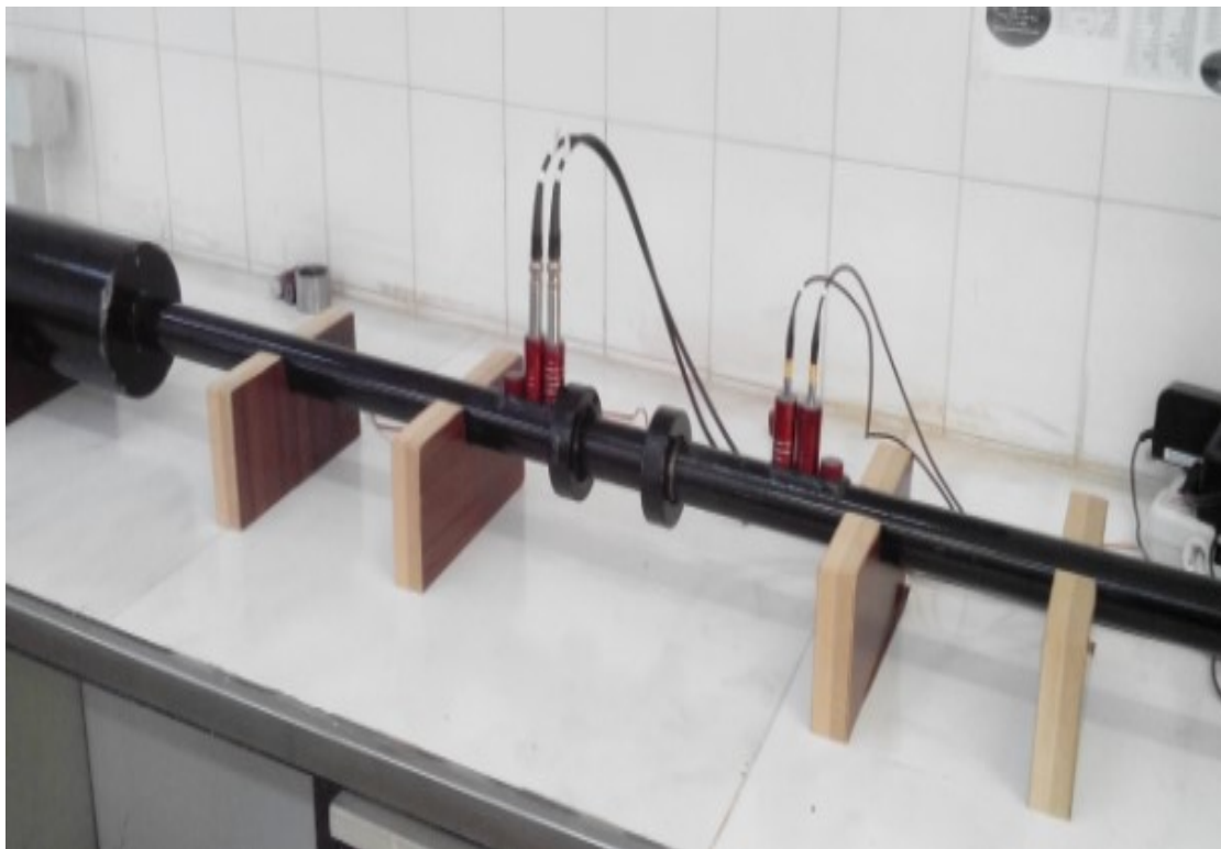
شکل (۳-۱) نمایی از لوله امپدانس طراحی شده
