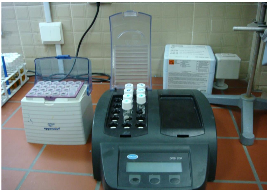
شکل ۴-۲- نمایی از راکتور COD مدل ۴۵۶۰۰
