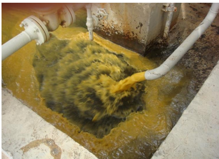
شکل ۳-۵- تخلیه مواد هیدروکربنی از بالای فیلتر ۳۰۲-D قبل از اجرای خط جدید تانک ذخیره کاستیک مصرفی
