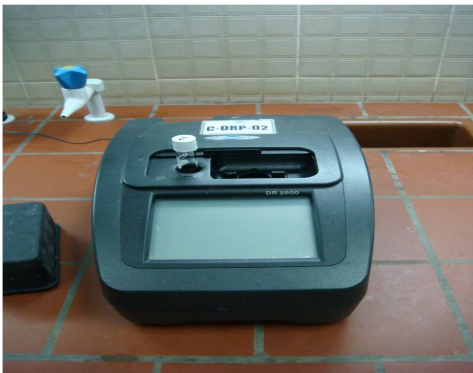
شکل ۴-۳- نمای از دستگاه HACH مدل DR/2400
