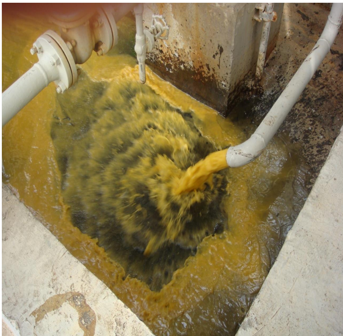
شکل ۳-۱۲- نمایی از تخلیه کردن فیلتر و خروج هیدروکربن
