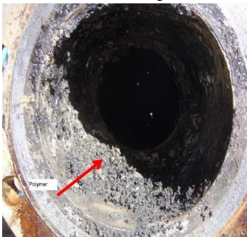
شکل ۳-۱۶- نمایی از تجمع پلیمر در مخلوط کننده
