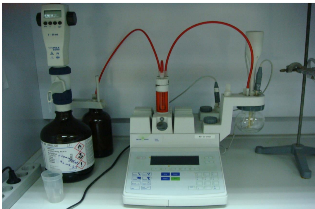
شکل ۴-۷- نمایی از دستگاه تیترا تور جهت تست درصد کاستیک
