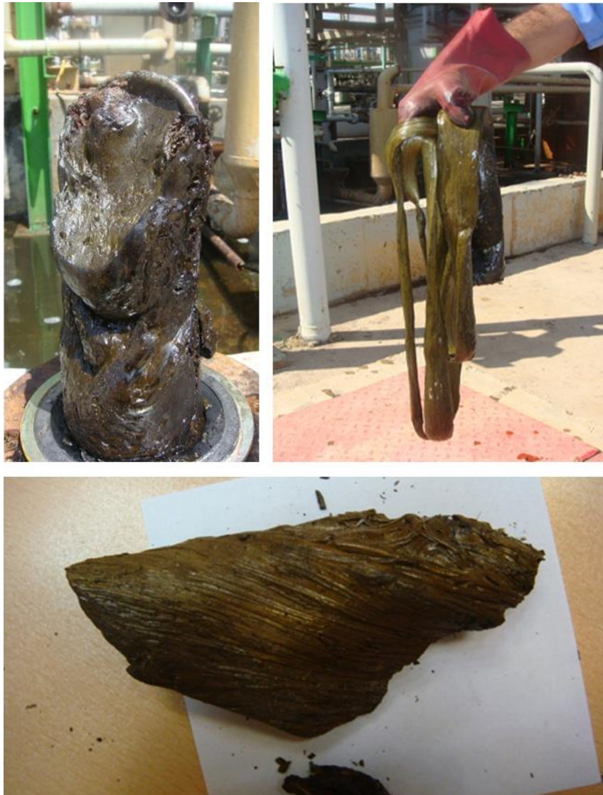
شکل ۳-۱۳- نمایی از پلیمرهای تشکیل شده
