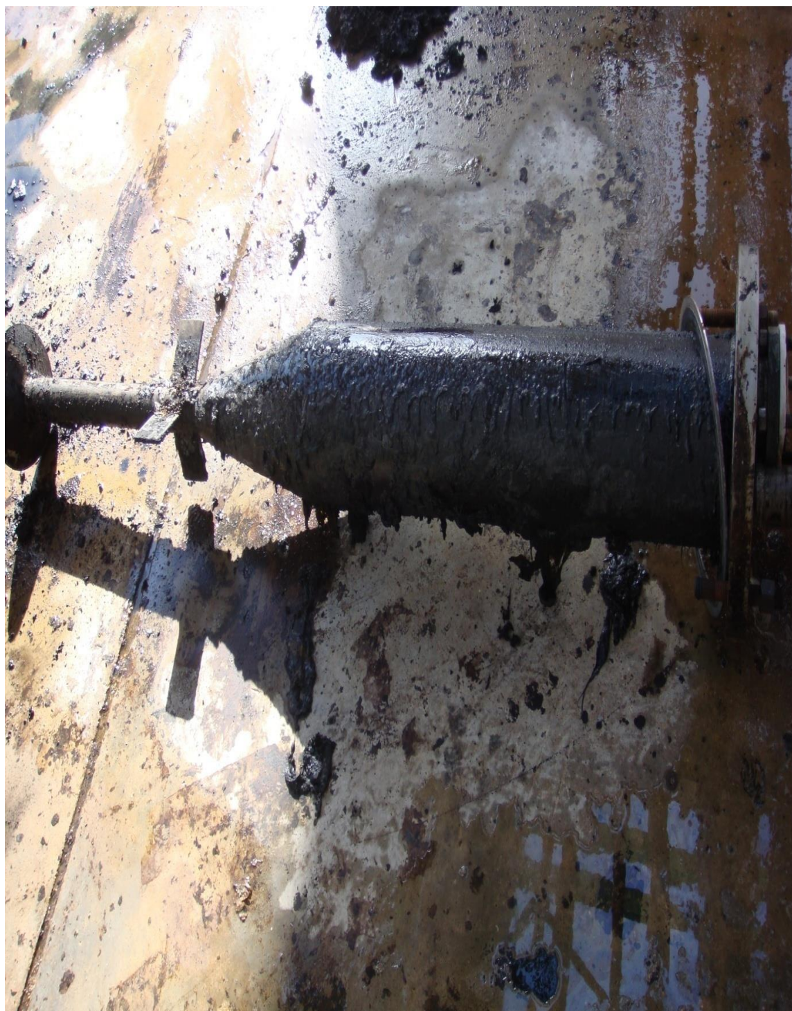
شکل ۳-۱۷- نمایی از مخلوط کننده اسید و کاستیک و تجمع پلیمر روی آن
