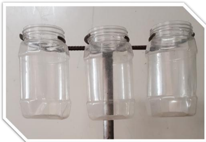
(شکل ۳-۴) تصویر قسمت نگهدارنده ظروف در سیستم تصفیه پساب
