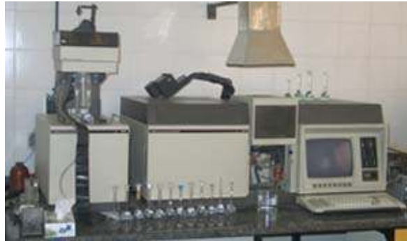
شکل (۳-۱). دستگاه طیف سنجی جذب اتمی (A.A)، مدل pu9200، مارک Philips
