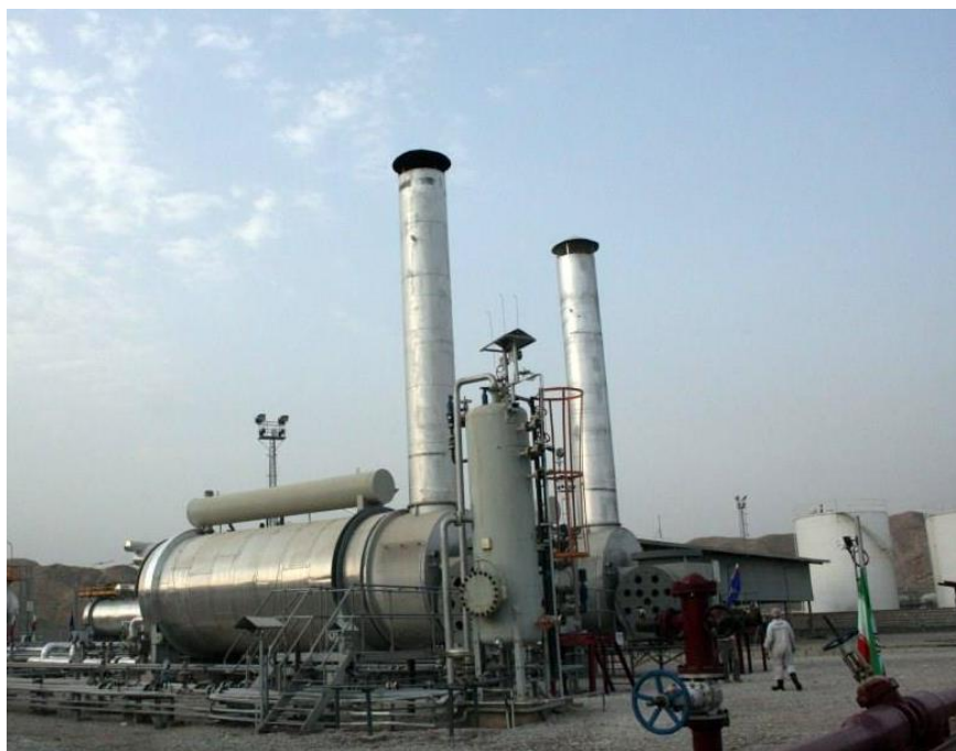
شکل (۲-۴) - نمایی از دو دستگاه پیش گرم کن در واحد نمک زدایی گچساران ۳ (۳۹)
