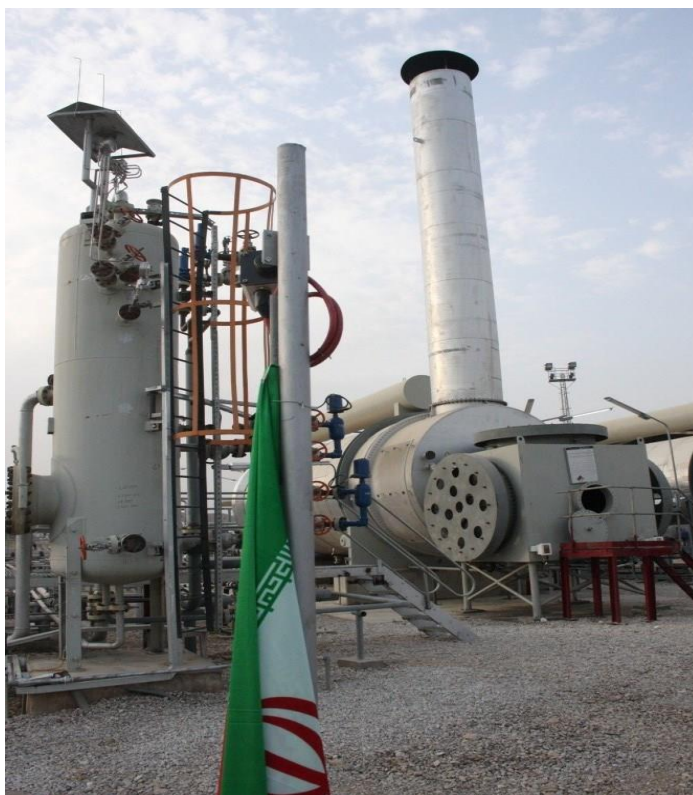
شکل (۶-۲) - نمایی از برج تفکیک اکسیژن در سمت چپ تصویر (۳۹)
