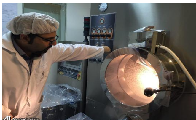
شکل ۳-۹- دستگاه تثبیت قرص ها پس از روکش شدن
