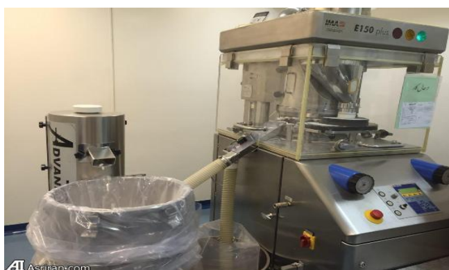
شکل ۳-۸- دستگاه پرس (مواد اولیه در این دستگاه پرس شده و به قرص تبدیل می شود).
