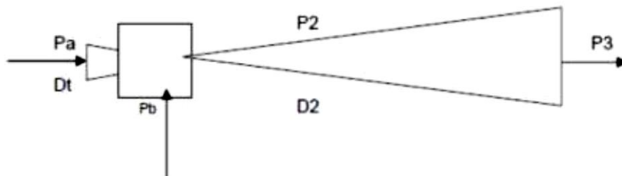
شکل ۳-۷ طرح شماتیک مشخصات طراحی و تعیین وضعیت کارکرد اجکتور (۲۸)
