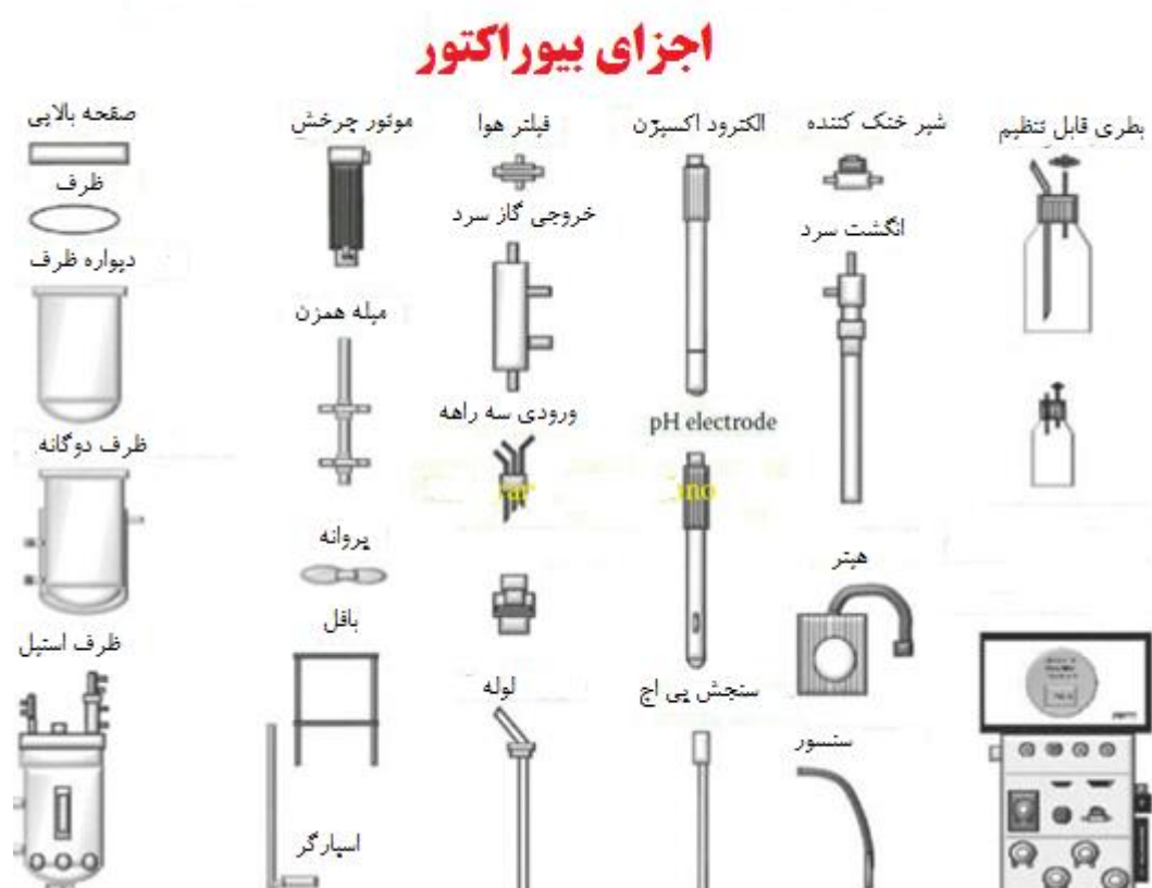
شکل ۳-۱ ترکیبات و اجزای بیوراکتور(۳).
