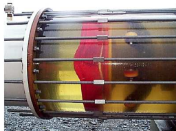
شکل (۱۶-۴) توقف پیگ به دلیل چفت و بست نامناسب آب بندها
