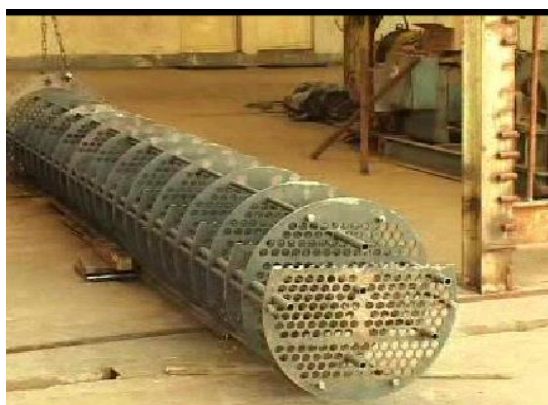
شکل (۱-۶) بافل ها (مغشوش کننده های جریان)
