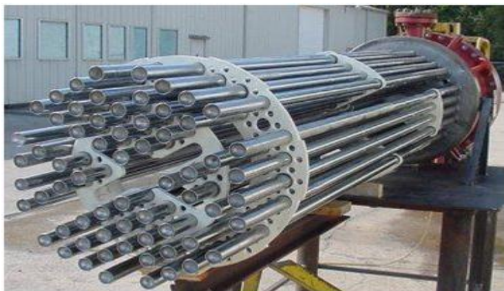
مبدل گرمایی پوسته-لوله که آرایش لوله های آن بصورت مثلثی است.
