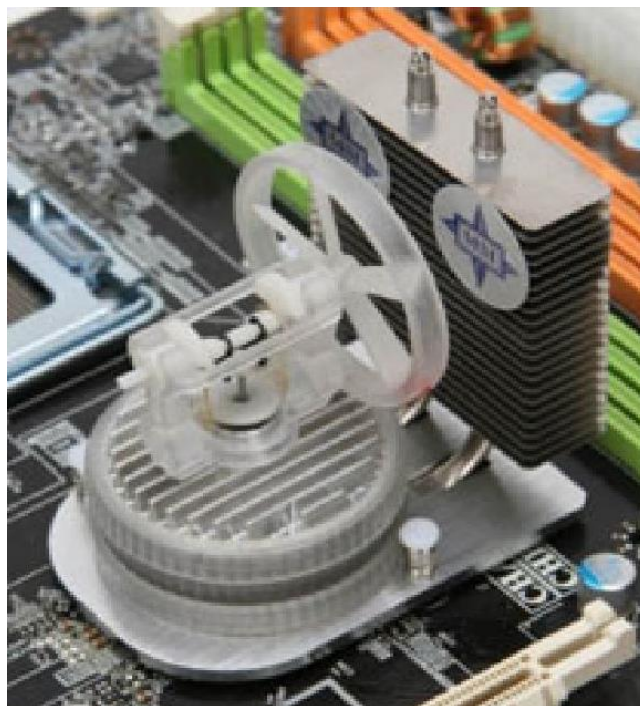
شکل (۱۵-۱) خنک کننده ی پردازشگر با استفاده از موتور استرلینگ ساخت کمپانی MSI
