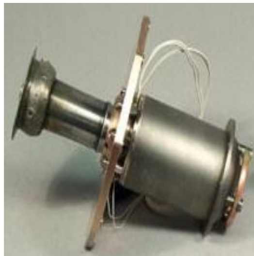
شکل (۱-۱۶) موتور استرلینگ ASC ۳ متعلق به GRC
