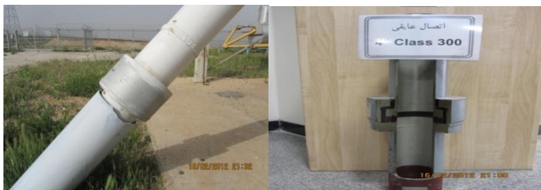
شکل (۳-۱۰) نمایه برش خورده ی اتصال عایقی
