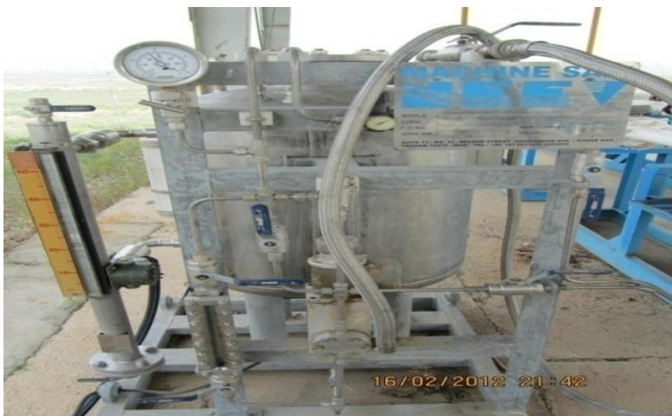
شکل (۳-۱۲) نمونه از بودار کننده ها (نگارنده)
