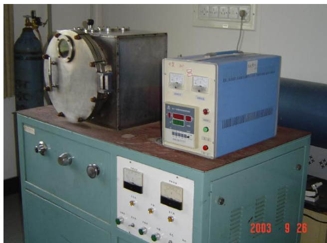
شکل (۲-۱۸) دستگاهی برای تهیه تک مرحله‌ای نانو سیال (۱۱).
