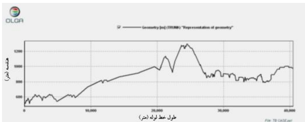
شکل ۲-۱- پروفیل خط انتقال گاز از مرکز جمع‌آوری تنگ بیجار به مرکز جمع‌آوری ایلام (۸)
