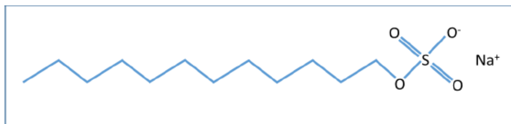
شکل ۱.۱. نمونه ای از ساختار سورفکتانت: دودسیل سولفات سدیم (SDS)
