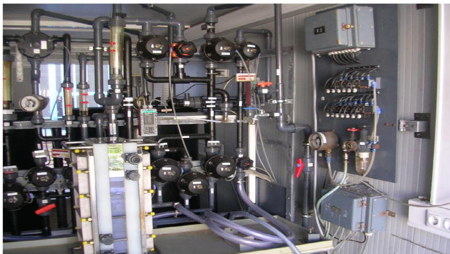
شکل ۲-۵- تصویر پایلوت الکترودیالیز طرح نیترات زدایی آب شرب گلشهر مشهد (۱۱۷)
