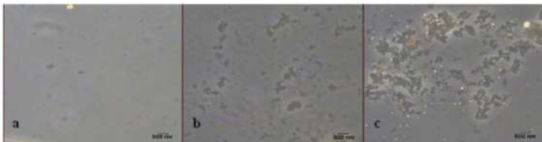
شکل ۴-۲- افزایش انباشتگی نانوذرات با افزایش زمان برای مخلوط آب اکسید مس ( \phi=0/1 ) (الف) ۲۰ دقیقه (ب) ۶۰ دقیقه (ج) ۷۰ دقیقه [۸]
