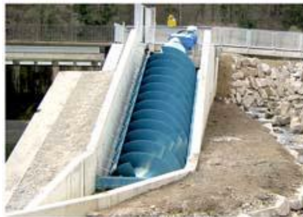
شکل ۲-۲ تصویری از توربین اسکروی ارشمیدوس (۲۶)
