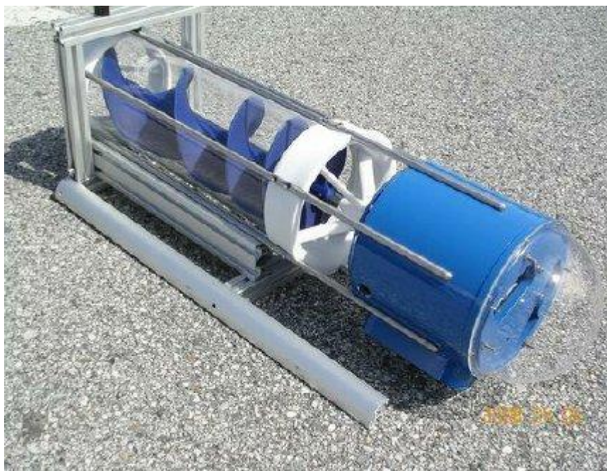
شکل ۳-۷ اتصال توربین به ژنراتور توسط شفت (۳۱)
