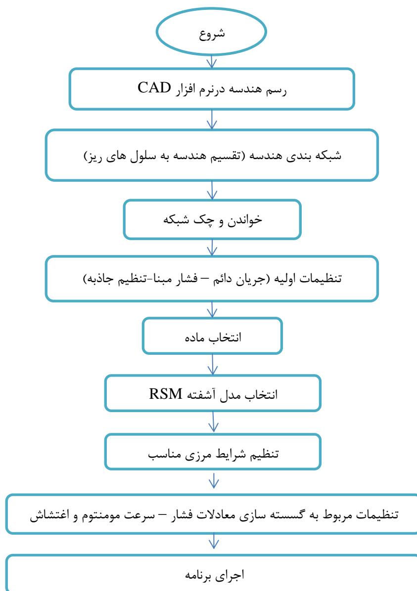
شکل ۳-۱ مراحل مختلف شبیه سازی مرحله به مرحله مدلسازی هیدروسایکلون
