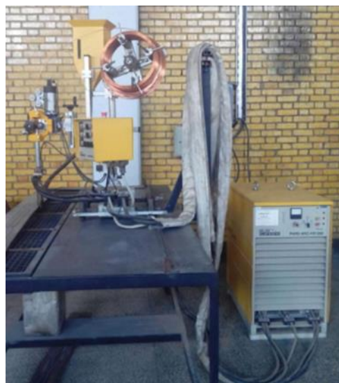
شکل ۳-۲ تجهیزات جوشکاری زیرپودری
