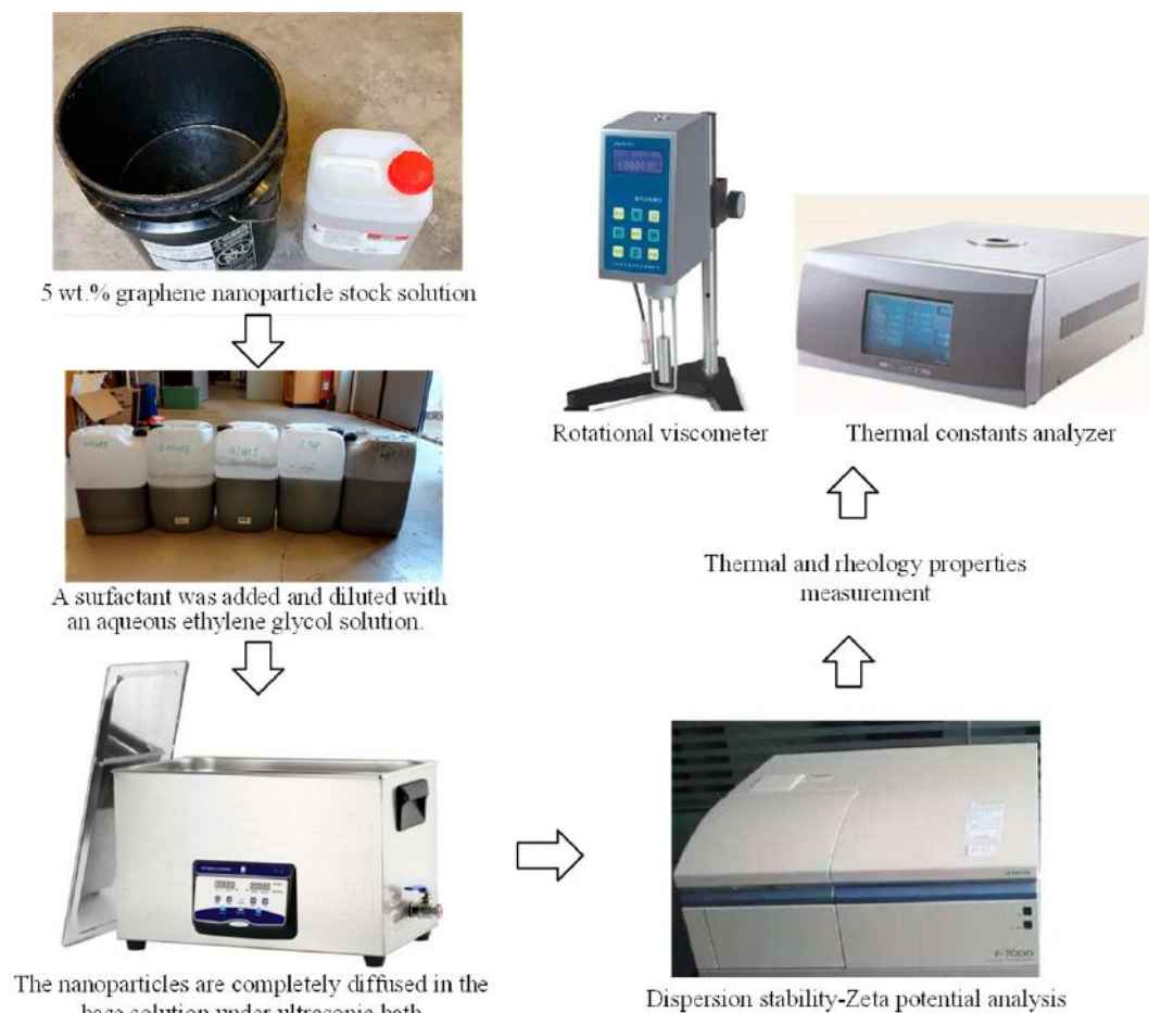
شکل (۴-۱) فرایند آماده‌سازی و سنجش خواص فیزیکی نانوسیال گرافن
