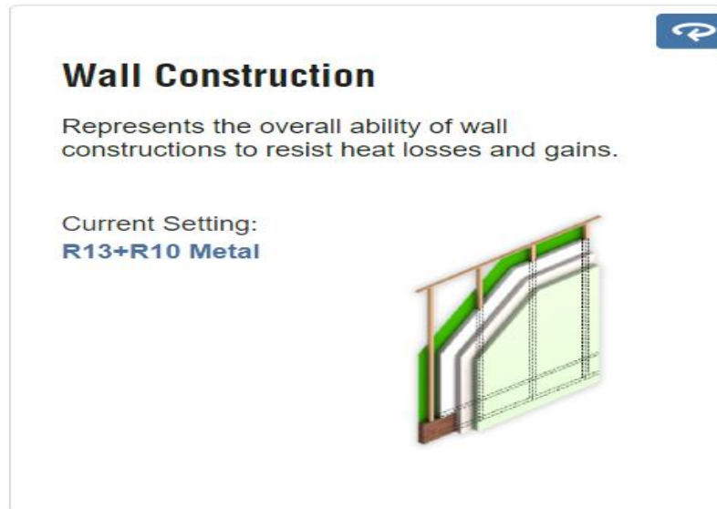
شکل (۴-۶۷) ساختار دیوار پیشنهادی در ساختمان دیزاین شده
