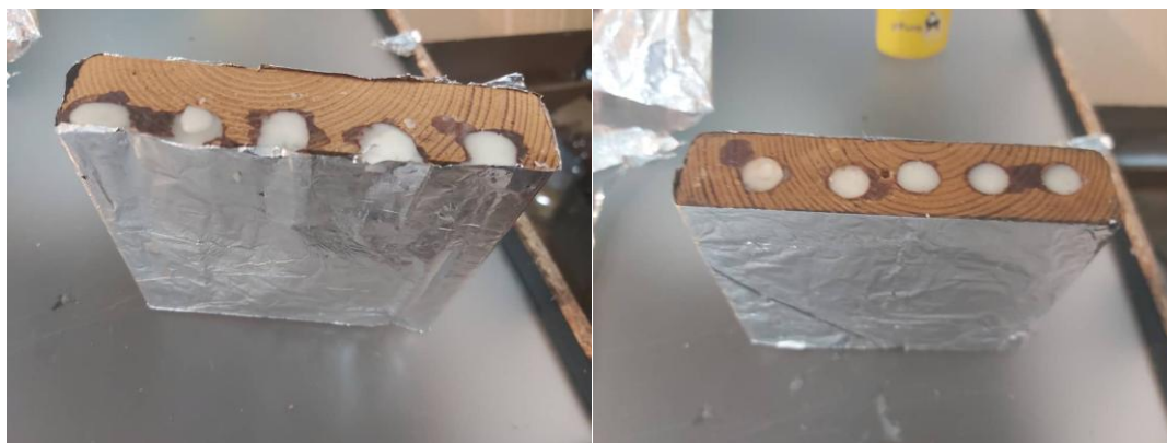
۲) تزریق پارافین در لایه میانی ترموود
