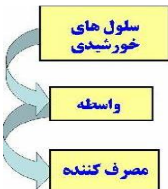
شکل ۳-۴- اجزای سیستم فتوولتائیک
