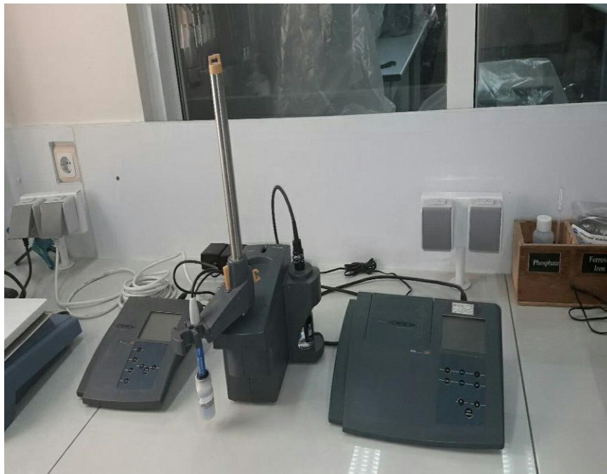
شکل ۳-۳- دستگاه ضریب هدایت حرارتی سنج
