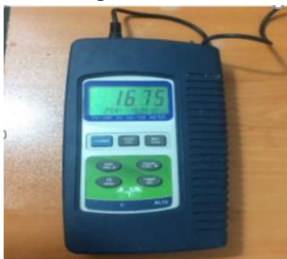
شکل ۳-۱- تصویر اندازه گیری رسانایی موثر الکتریکی
