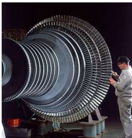
شکل (۱-۵) نمونه ای از یک توربین بخار چند محوره
