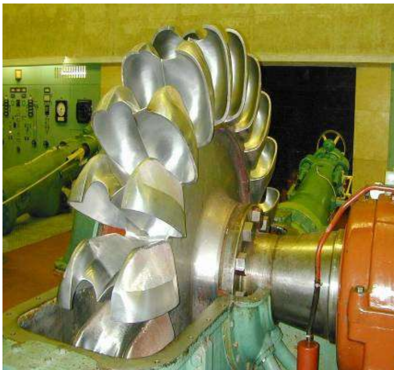
شکل (۱-۴) نمونه ای از توربین چرخ پلتون
