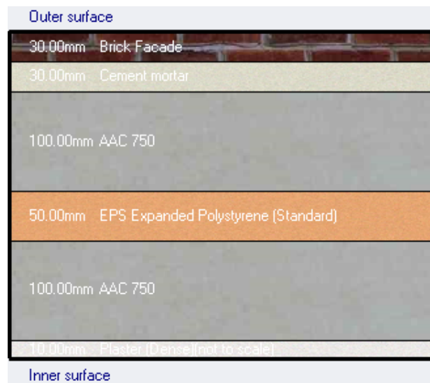
شکل (۴-۲۷) مصالح به کار رفته در دیوار خارجی با آجرنما
