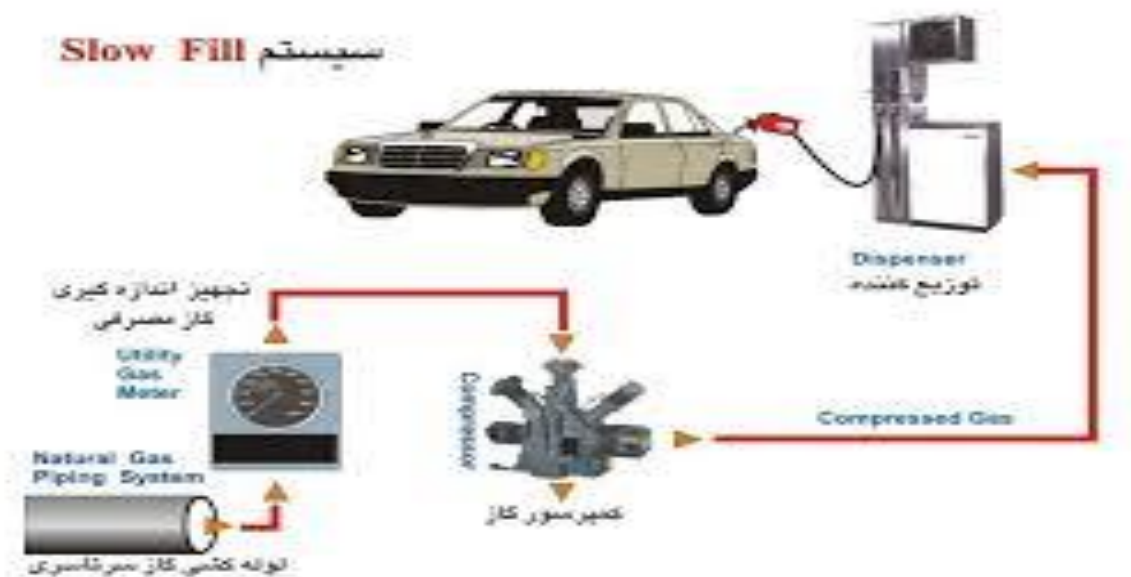
شکل ۲-۲ نمایی از نحوه دریافت فشرده سازی و توزیع CNG ایستگاه سوخت رسانی کند
