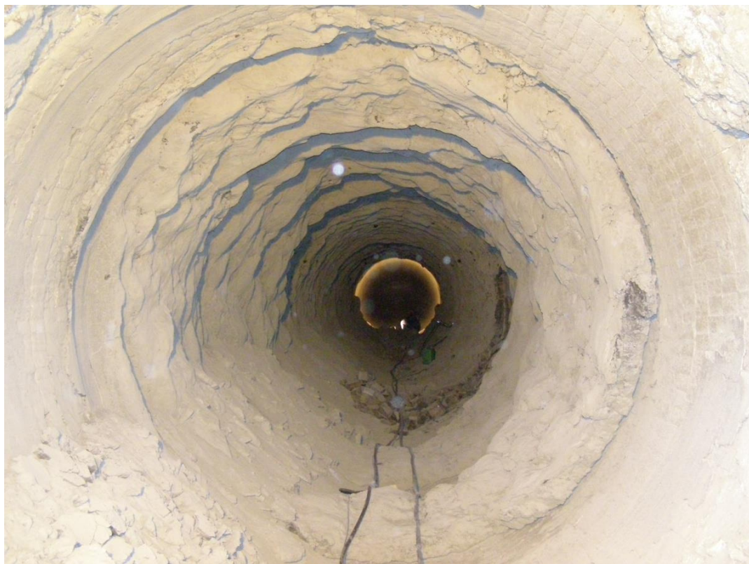
شکل ۳-۵ کوتینگ روی آجرچینی های کوره
