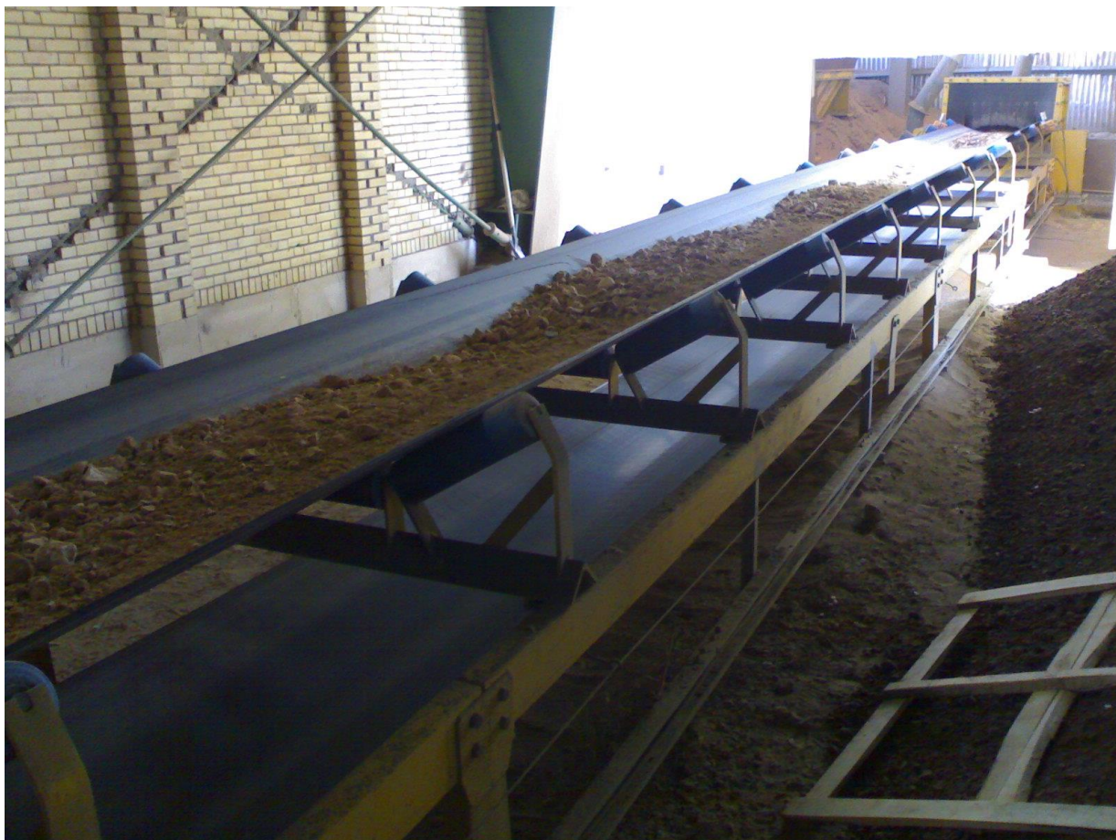
شکل ۵- ۱ مواد روی نوارهای توزین جهت انتقال به آسیاب مواد
