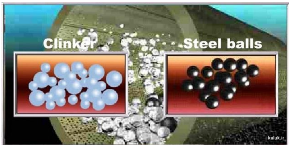
شکل ۱۱- ۱ آسیاب کلینکر و ترکیب توپ های فولادی با کلینکر
