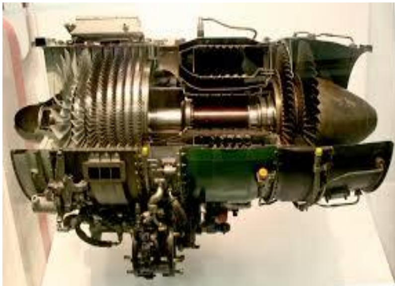
شکل (۲-۳): نمایی برشی از درون یک میکرو توربین [۱۶].
