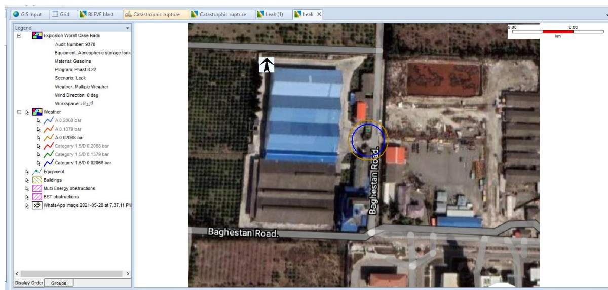
شکل (6-7) موج انفجار ناشی از نشت 10 mm
