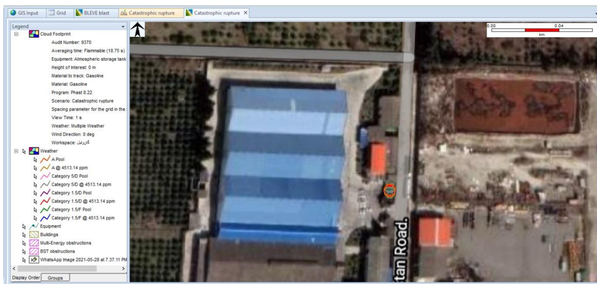
شکل (3-6) ابر بخار ناشی از سناریو گسست ناگهانی
