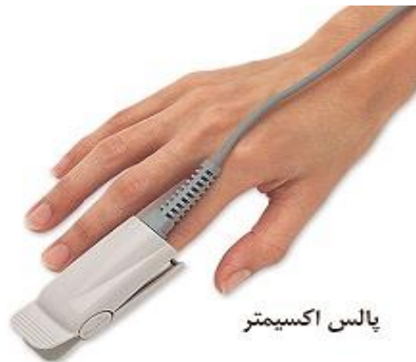
شکل (۸-۳) محل نصب پراب پالس اکسی متر
