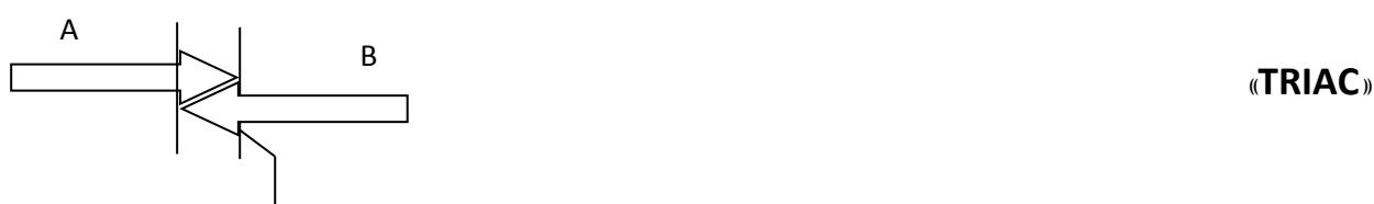
در هر دو جهت هدایت دارد بسته به اینکه ولتاژ A از B بیشتر باشد و یا B از A در یکی از آن دو جهت عبور جریان خواهد داشت مشابه با (AD/DC) تریستور برای اینکه روشن شود بایستی به پای Gate یک ضربه‌ی ولتاژ (پارس سوزنی (باریک هستند) اعمال شوند تا TRIAC روشن شود از TRIAC در کنترل الکتروموتورهای «سنکرون» AC و «آسنکرون» AC استفاده می‌شود.
