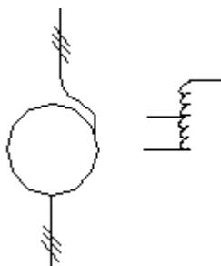
، اتو ترانسفورماتور سه فاز که برای تولید ولتاژ متغیر است :
