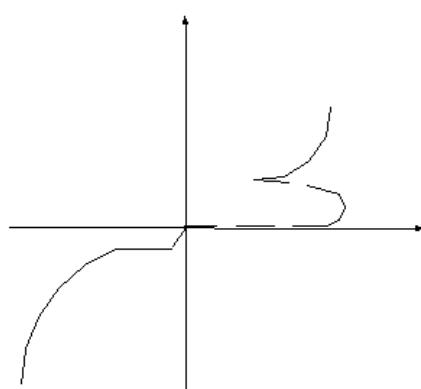
در قسمت مثبت یک جایی که آتش گیت ایجاد کنیم مقاومت صفر ولتاژ بالا است در قسمت پر رنگ تغییرات ولتاژ نمایی است برای روشن شدن SCR دو شرط لازم است که یکی از شروط اضافه بر دیود است
