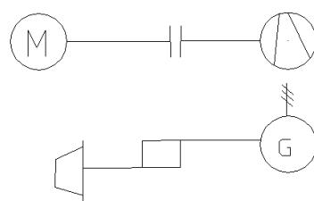
کمپرسور با راه انداز موتور و کوبلاژ قابل تنظیم :
