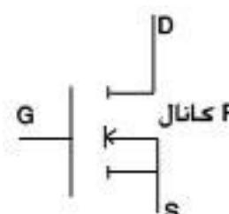
ناحیه کار : ۱ - خاموش  $V_{GS} < V_T$
