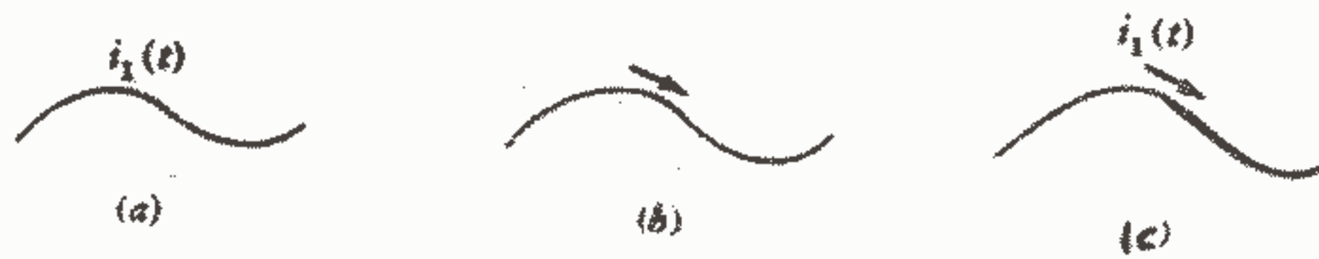
شکل ۱-۶: (a) و (b) تعاریف ناقص، نامناسب و غلط یک جریان می‌باشند. (c) تعریف صحیح i_1(t) .
