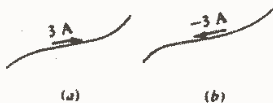
شکل ۳-۵: دو روش برای نشان دادن یک جریان واحد.
