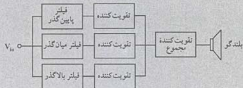
شکل ۱۶-۴۴ نمودار بلوکی یک مدار برابر‌ساز گرافیکی ساده.
