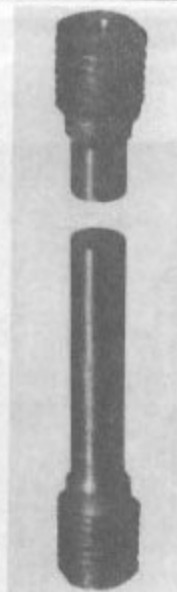
شکل ۲-۱۲ نمونه آزمایشی یک ماده شکننده.
