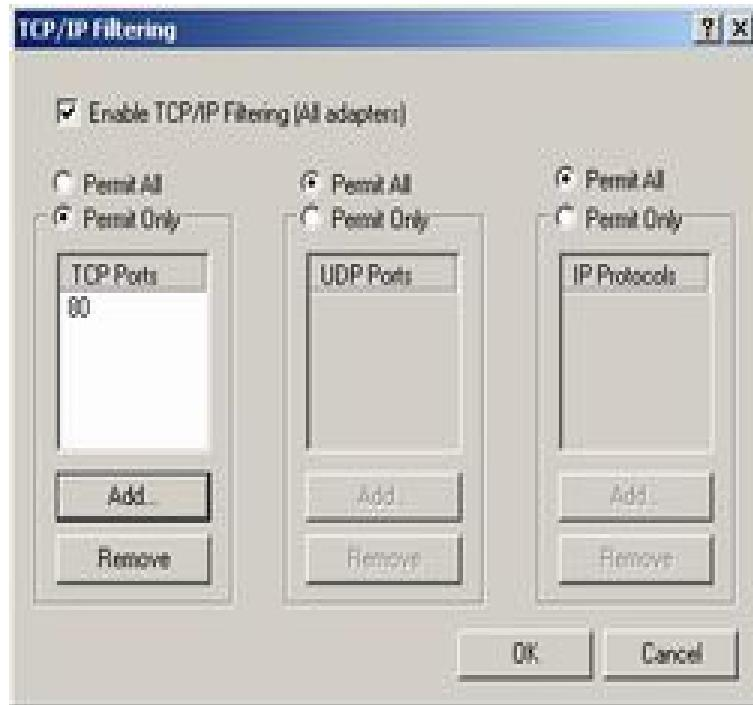
همانگونه که در شکل فوق مشاهده می گردد ، در قسمت بالای پنجره TCP/IP Filtering یک check box به منظور فعال و یا غیرفعال نمودن ( Enable All Adapters ) TCP/IP Filtering وجود دارد . پنجره فوق به سه ستون TCP و UDP Ports ، Ports IP Protocols تقسیم شده است که هر یک دارای مجموعه ای از دکمه های Radio button می باشند . مقدار پیش فرض Radio button موجود در هر ستون ، Permit All در نظر گرفته شده است . بدین ترتیب به تمامی بسته های اطلاعاتی این اجازه داده می شود که بدون هیچگونه فیلترینگی در
