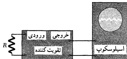
شکل ۱-۲۶. مقاومت R متصل به دو انتهای ورودی یک تقویت کننده حساس که خروجی آن به اسیلوسکوپ متصل است.
