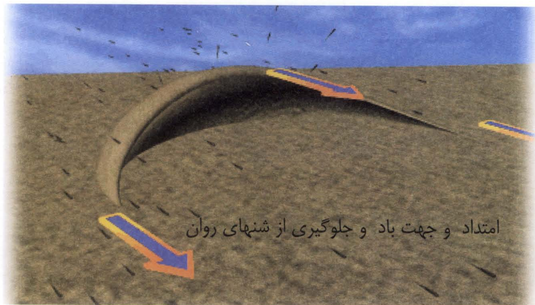
شکل ۱۶-۷: حرکت شنهای کویر را در محدوده دلخواه میتوان با سازه‌های سنگین متوقف نمود.
