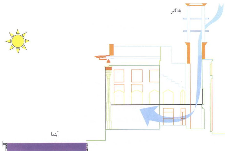
شکل: ۱۱-۲۹- ورود جریان هوا از ضلع شمالی بادگیر به داخل طبقه زیرین ساختمان، و خروج هوا از طبقه فوقانی و از ضلع جنوبی بادگیر خواهد بود.
