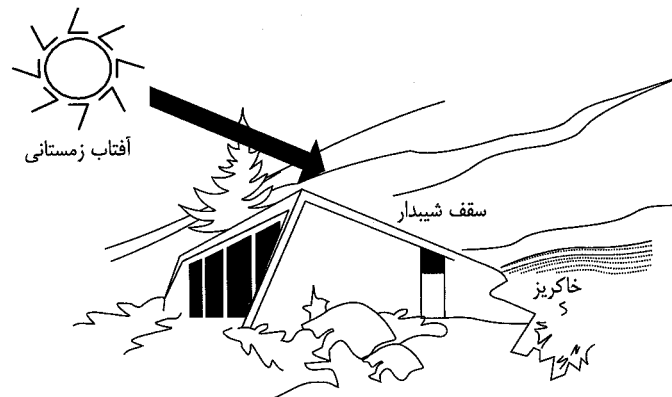
شکل: ۱۰-۱۲- شیب از جنوب به شمال پشتمان موجب کاهش افت حرارت، و رسیدن نور خورشید به قسمت شمالی فضای داخلی می شود.
