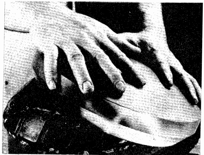
شکل ۷.۵ پرداخت عدسی کروی.
