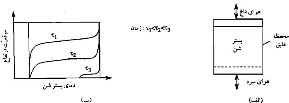
شکل ۵-۱۰. ذخیره سازی گرمای محسوس با بستر شن: الف - شکل شمایی،
